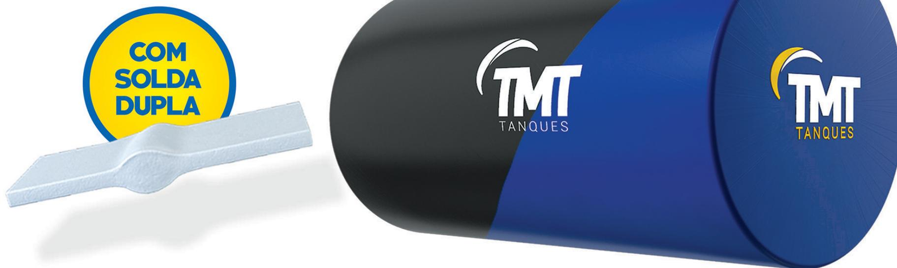
Os tanques Jaquetados TMT para uso subterrâneo destinados ao armazenamento de combustíveis, são formados por tanque primário construído em aço carbono e o tanque secundário em resina termofixa reforçada com fibra de vidro laminada (PRFV), dando dupla proteção ao tanque e permitindo o monitoramento ininterrupto do espaço intersticial.
