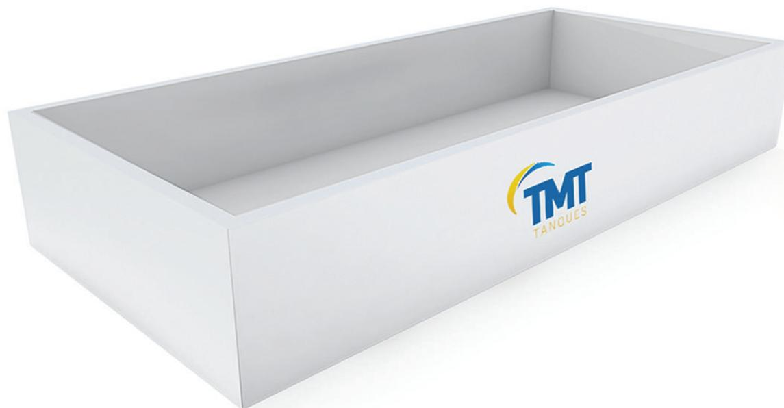
A TMT oferece, como opcional para os tanques aéreos horizontais, a bacia de contenção em aço carbono de acordo com a NBR 15.461. A bacia conta com capacidade de contenção para 110% do volume do tanque, preservando, assim, o meio ambiente. Entre seus benefícios, o uso da bacia de aço facilita a mobilidade do equipamento completo sem a necessidade de construção de novas contenções.
