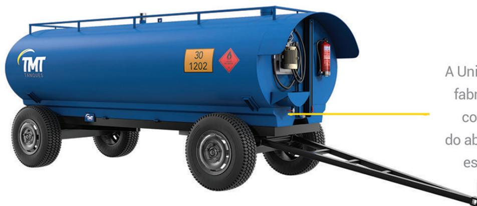
A Unidade rebocável para abastecimento é composta por tanque fabricado em aço carbono, bomba de abastecimento compacta com filtro e reboque para área rural ou urbana. O acionamento do abastecimento através da tomada de força do trator ou motor estacionário viabiliza a mobilidade do equipamento em toda a propriedade, evitando o deslocamento da máquina agrícola.
