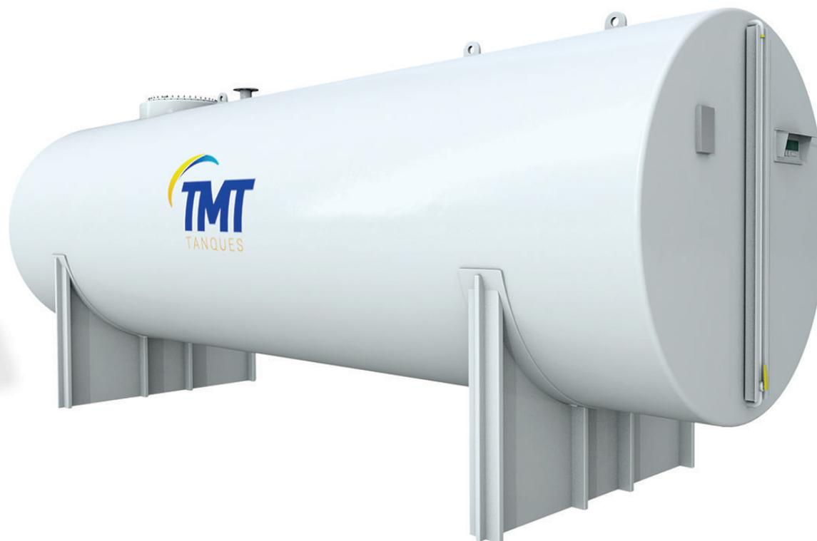
Fabricados em aço carbono ou inox, os tanques aéreos podem ser nos formatos horizontais (fornecidos com berços metálicos ou reforços estruturais nos costados) ou verticais (com fundos planos, decimais ou cônicos), sempre em conformidade com as mais rígidas normas nacionais e internacionais, como a NBR 15.461.
